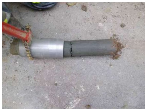
Figure 38 : Vue de de la carotte de sol prélevée entre 1,6 et 2 mètres de profondeur sur le sondage S84
