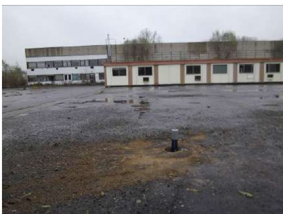
Figure 65 : Vue de l'implantation du piézair Pzair S105
