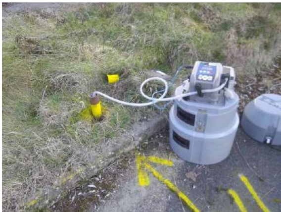
Figure 87 : Vue de la réalisation du prélèvement sur le piézomètre MW4/13
