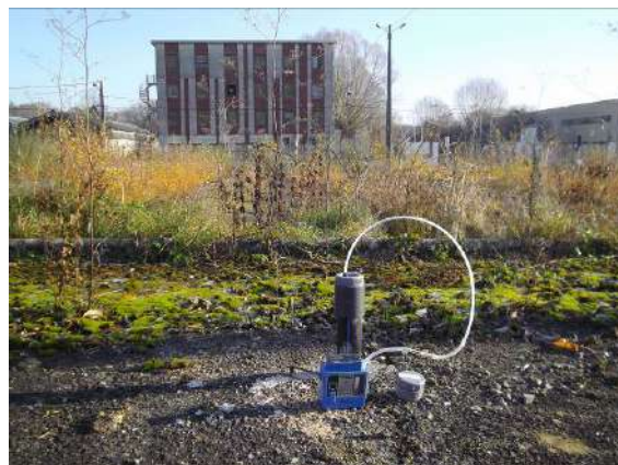
Figure 68 : Vue de la réalisation du prélèvement sur le piézair Pzair S71bis
