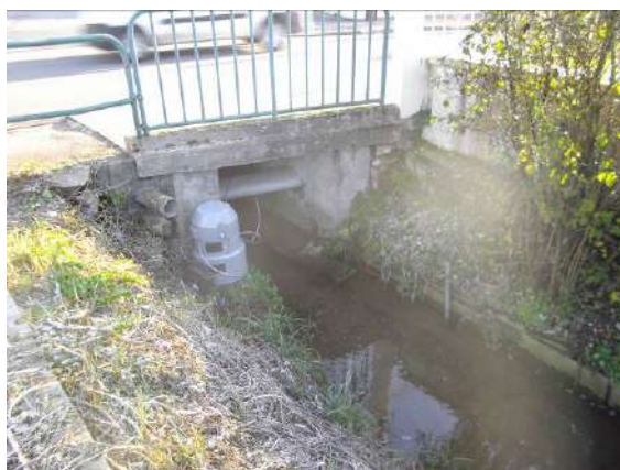
Figure 82 : Vue de la station de prélèvement des eaux superficielles sur le ruisseau de la Motte
