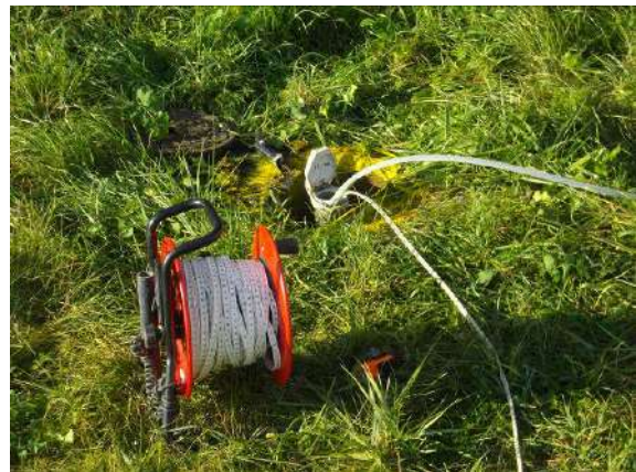
Figure 88 : Vue de la réalisation du prélèvement sur le piézomètre MW12
